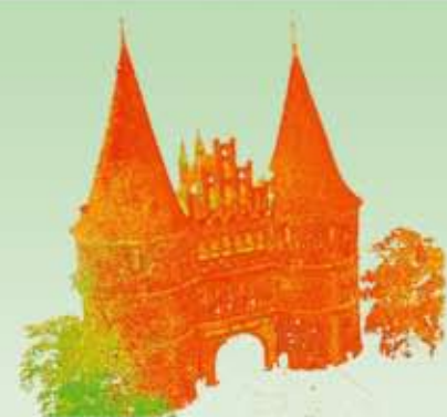
2. Milijonai taškelių, gaunamų skenuojant, sudaro tam tikrą vaizdą. Šis „debesis“ – tikslus skenuoto pastato kontūrų atvaizdas.
