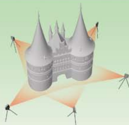
1. Lazeriniai skeneriai nuo pastato, kurio modelį reikia sukurti, statomi 100–200 metrų atstumu. Kaskart į pastatą paleidus signalą, matuojamas laikas, per kurį jis grįžta atgal. Taip gaunama daug taškelių.
